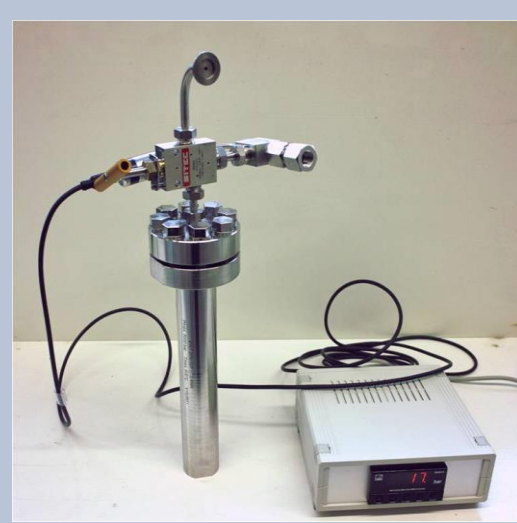
Autoklav aus Inconel für ammonothermale Synthesen.
