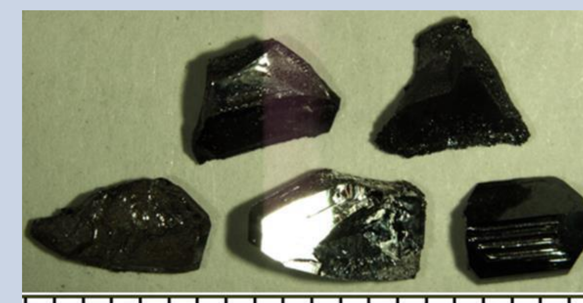
Kristalle von \text{BaFe}_{12-x}\text{Al}_x\text{O}_{19} mit mm-Skala.
