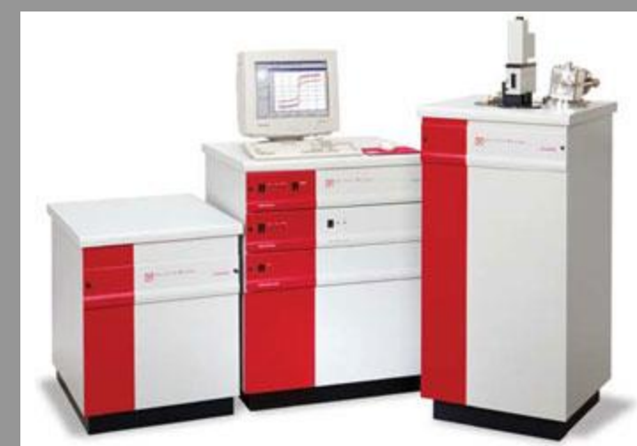
Abb. 10: SQUID-Magnetometer zur Messung magnetischer und supraleitender Eigenschaften bei tiefen Temperaturen (4 K bis 298 K, Abb. Quantum Design).
