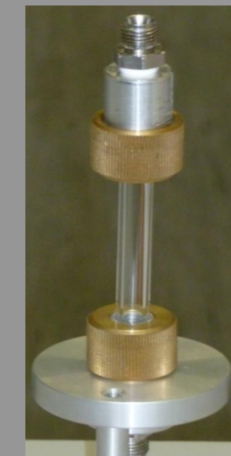
Abb. 7: Quarzglaszelle für die in-situ Neutronenbeugung (links). Aufbau am Neutronendiffraktometer D20, ILL, Grenoble (mitte). Neutronendiffraktometer D20, ILL, Grenoble (rechts).
