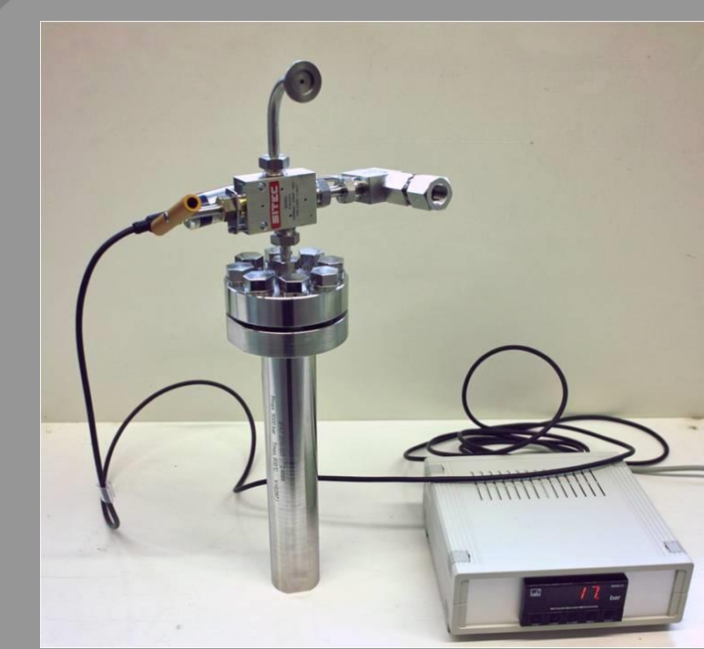
Abb. 14: Autoklav hergestellt aus einer Ni-basierten Speziallegierung ( p_{\text{max}} = 3 kbar, T_{\text{max}} = 600 °C) mit vorinstalliertem Druckmesser für die Ammonothermal-Synthese.
