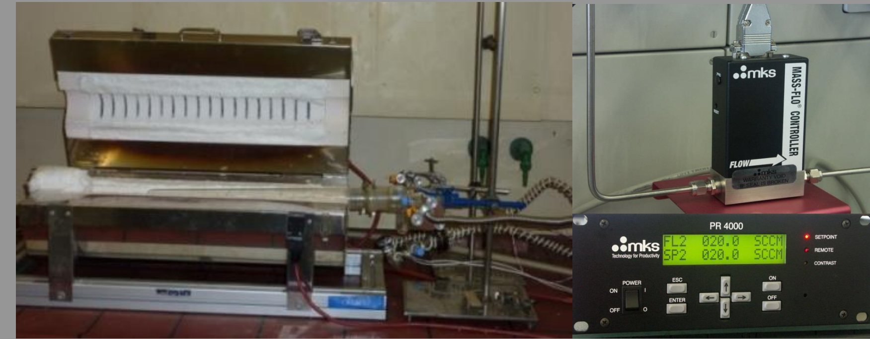
Abb. 5: Klappofen für Reaktionen im definiertem Gasstrom ( \text{NH}_3 , \text{H}_2 , \text{CO}_2 ) mit den entsprechenden Reglern für definierte Gaszusammensetzungen.
