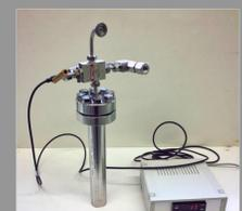
Autoklav aus Inconel (spezielle Ni-Legierung;  $p_{max} = 3$  kbar,  $T_{max} = 600$  °C) für hochkorrosives  $NH_3$ .
